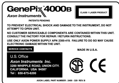
Figura 1. Etiqueta con Advertencias y Contactos para Reparación La etiqueta está fijada a la parte posterior del GenePix 4000B en la mitad superior de la cubierta protectora.
